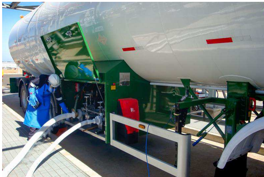
Ilustración 3. Carga de una cisterna con GNL de un trabajador de la empresa.
