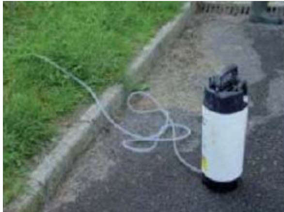
Imagen 28. Bomba aspiración para fibras de fibrocemento
