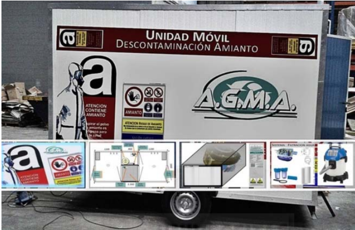
Imagen 19. Unidad de descontaminación tipo.
