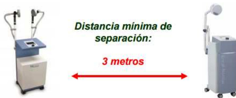
Figura 13: Distancia entre equipos
