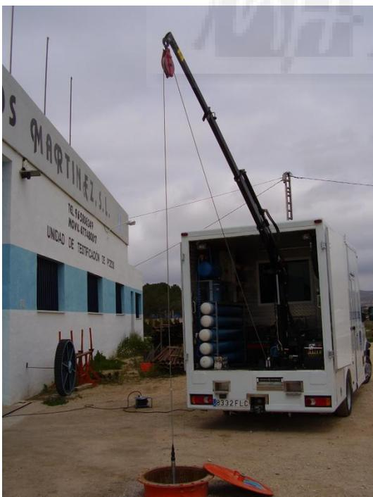
Foto. Equipo de testificación con grúa en sondeo.
