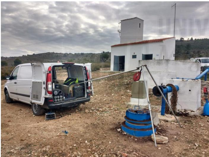
Foto. Equipo de testificación en sondeo.
