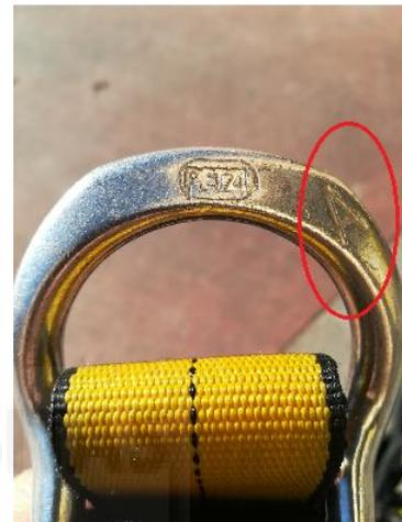
Imagen 10. Marca "A" indicando la colocación del anticaídas.
