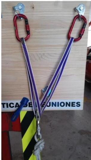
Triangulación a dos puntos direccional
