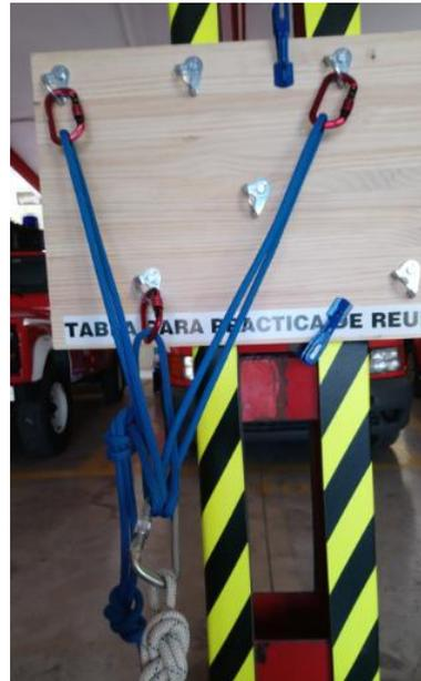
Anclaje con repartidor de carga
