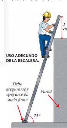
Ilustración 7: Esquema sobre uso adecuado de escaleras
