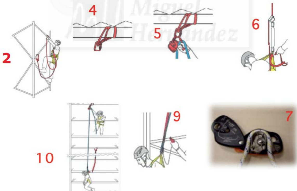
Ilustración 9: Esquema de pasos a seguir para el rescate en altura
