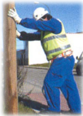
Ilustración 13: Oscilación del poste
