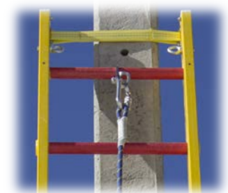
Ilustración 6: Punto de anclaje en la escalera
