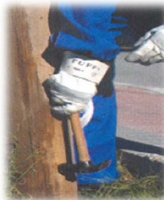
Ilustración 12: Golpeo del poste con un objeto contundente
