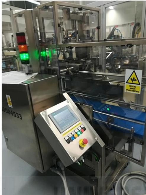
**Figura 66.** Señalización riesgo aplastamiento de manos y eléctrico
