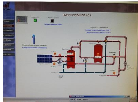
Control Tª automático de la instalación (i)
