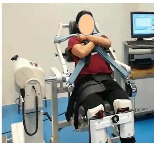
**Figura 1.** Test isométrico de flexión del tronco en dinamómetro isocinético.
