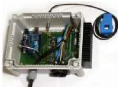
Figura 3-3 Inhibidor de corriente a red
