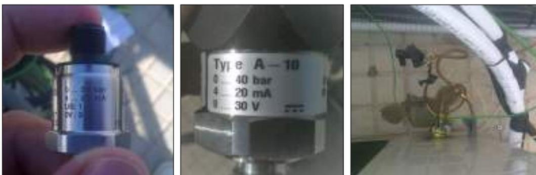
*Figura 2-7 Transductores de presión instalados*
