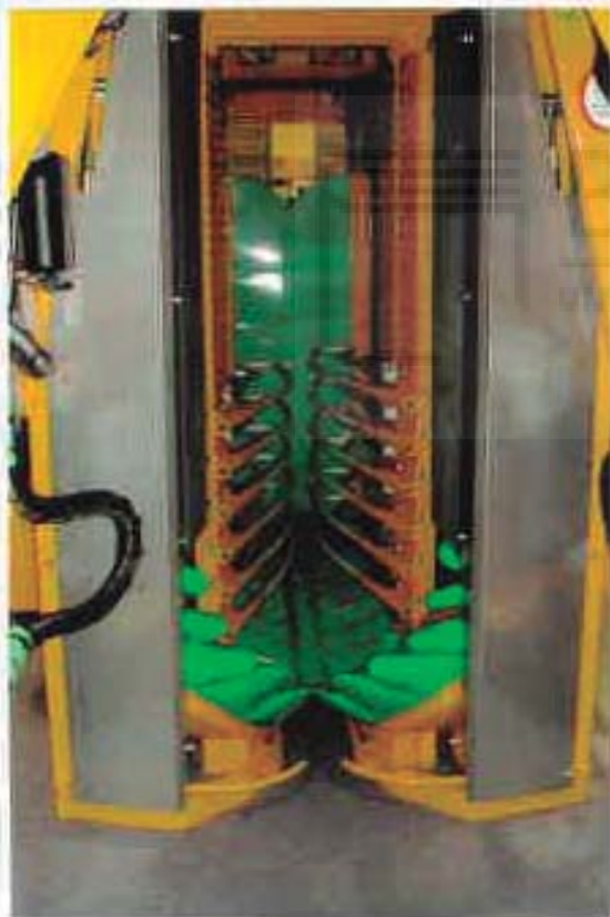
Foto 64. Detalle de los órganos de vibrado y recogida de uva en vendimiadora
