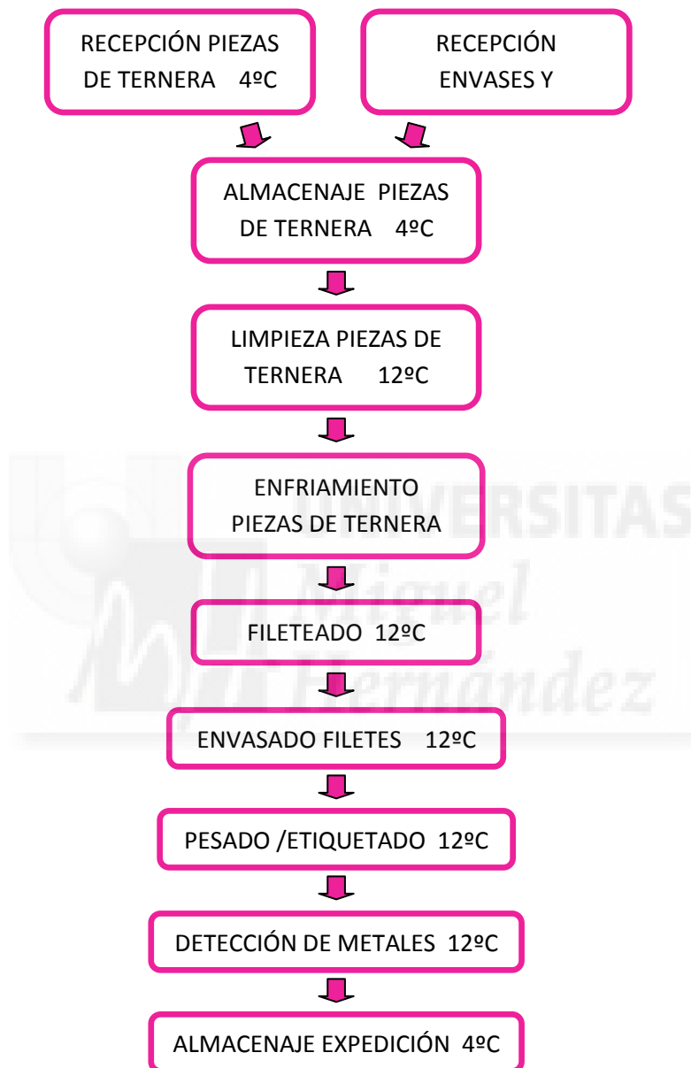
Figura 5: Diagrama de producción de EMENCA S.L. (Proceso de manipulación y envasado de carne)
