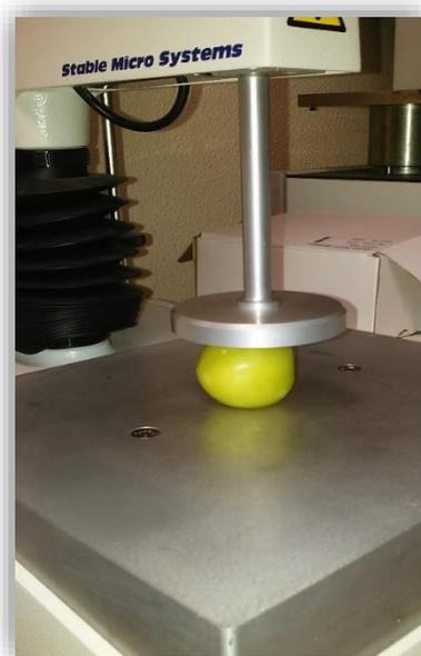
Foto 9. Posición del fruto en la prensa hidráulica
