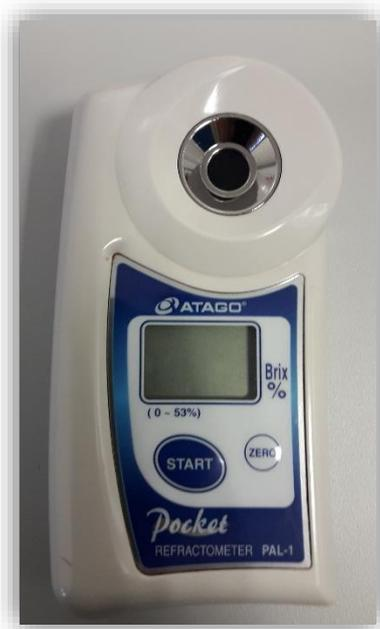
Foto 10. Refractómetro digital Atago gama PAL-1.
