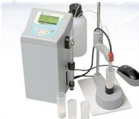
Figura 13: pHmetropHmatic 23 CRISON utilizado para medir la acidez.
