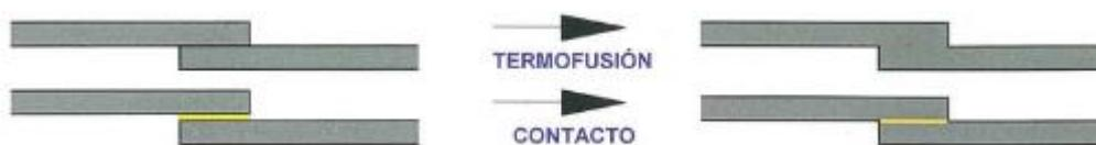
Figura 6. Detalle uniones entre láminas impermeabilizantes
