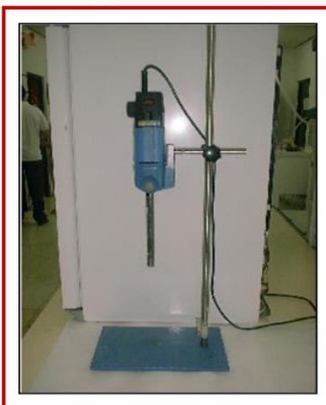
**Fotografía 5. Polytron utilizado para la homogeneización de las muestras.**
