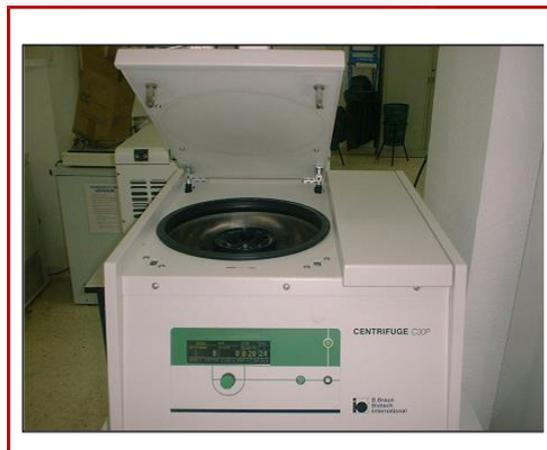
**Fotografía 6. Centrifuga C30P CENTRIFUGE utilizada para realizar las extracciones.**
