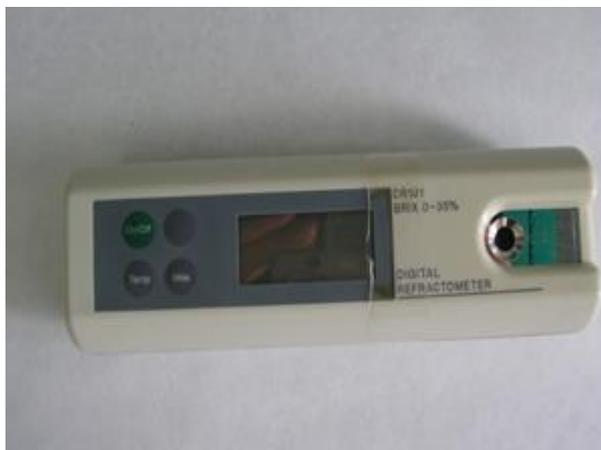
*Fotografía 9:* Refractómetro utilizado para medir los °Brix (SST).
