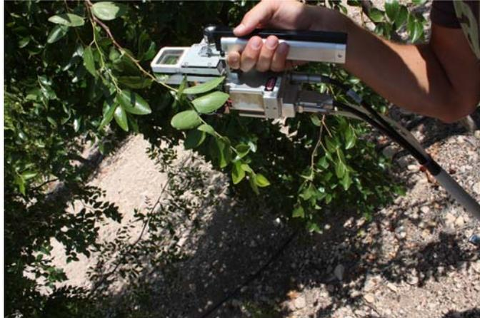
**Fotografía 4.2.** Medida de conductancia foliar ( $g_l$ ) y fotosíntesis neta ( $P_n$ ) con un medidor LI-6400 (LICOR Inc., Lincon, USA)
