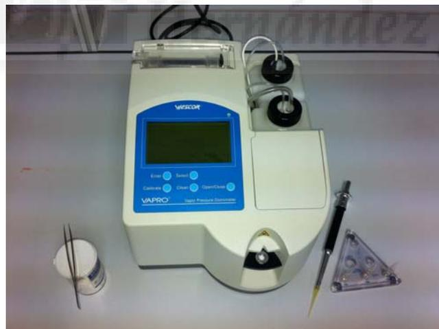
**Fotografía 4.4.** Osmómetro de presión de vapor (Wescor 5600, Logan, USA) para medida de potencial osmótico.
