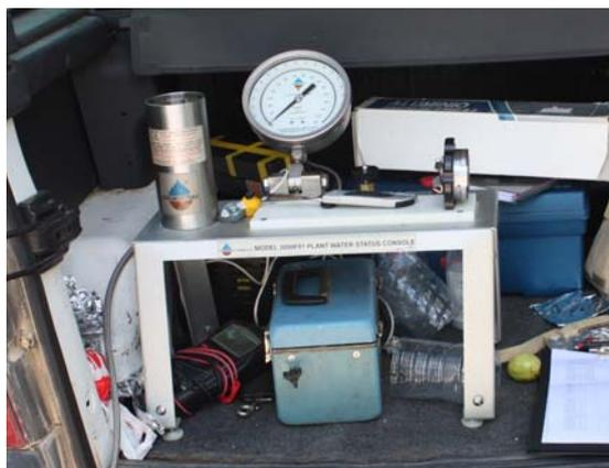
**Fotografía 4.3.** Hoja cubierta con lámina de aluminio y cámara de presión (Soilmoisture Equipment Corp., modelo 3005) utilizada para medir el potencial hídrico de tallo ( $\Psi_{stem}$ ).
