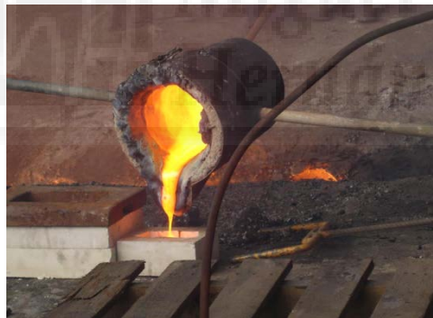
Figura 32. Operación de colado manual del fundido de residuos de Cr (VI) sobre moldes paralelepípedos después de la fusión en un horno de cubilote convencional pero usando carbón de coke como combustible (Planta de Ciateq, México) (fotografía tomada por Ballesteros en 2005)
