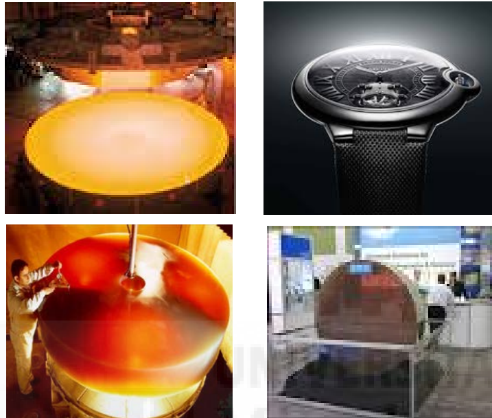
Figura 23. Se muestran diversos aspectos de materiales vitrocerámicos de \beta -espodumena para espejos de telescopios de reflexión (Zerodur®), así como para esferas de relojes de alta gama (fotografías de Zerodur para telescopios tomadas de la revista Schott Information y de Zerodur para esferas de relojes del google image a su vez tomada de cronoforum.com )
