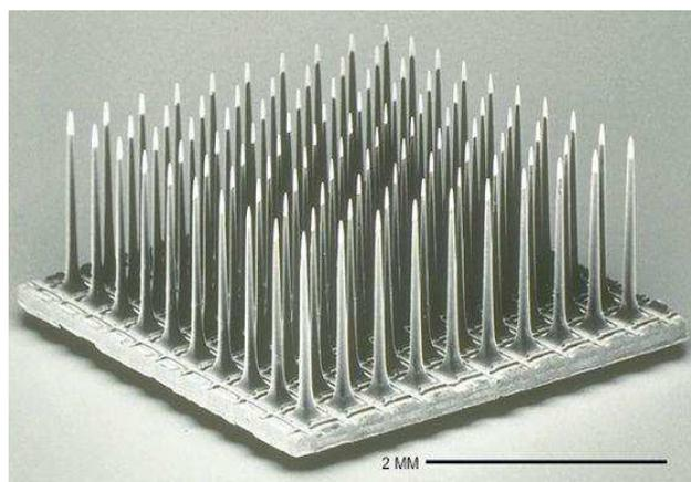
Figura 1.8: Matriz de multielectrodos de Utah.
