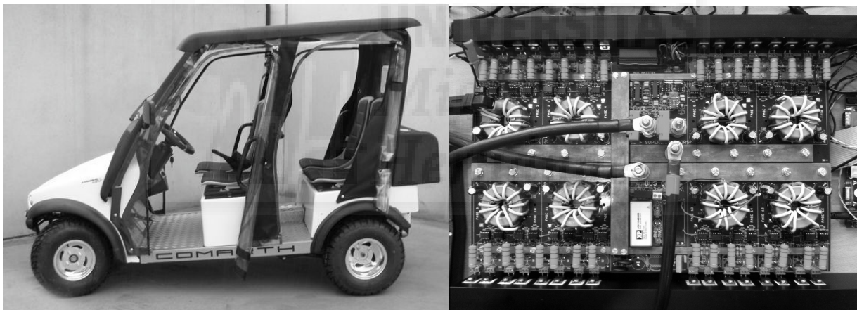
Figura 1.6: Vehículo de proximidad Comarth Engineering S.L. Cross Rider 4P (arriba) y convertidor DC/DC bidireccional diseñado (abajo); descrito en [12].
