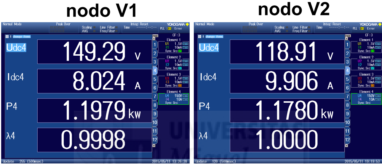
Figura 5.7: Detalle de las pantallas del vatímetro empleado para la medida de eficiencia del convertidor.
