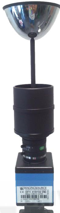
**Figura 3.1:** Sistema de adquisición de imágenes omnidireccionales. Está compuesto por una cámara CCD apuntando hacia un espejo hiperbólico.
