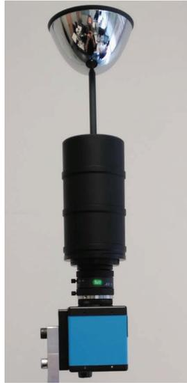
**Figura 6.5:** Sistema de adquisición de imágenes omnidireccionales.
