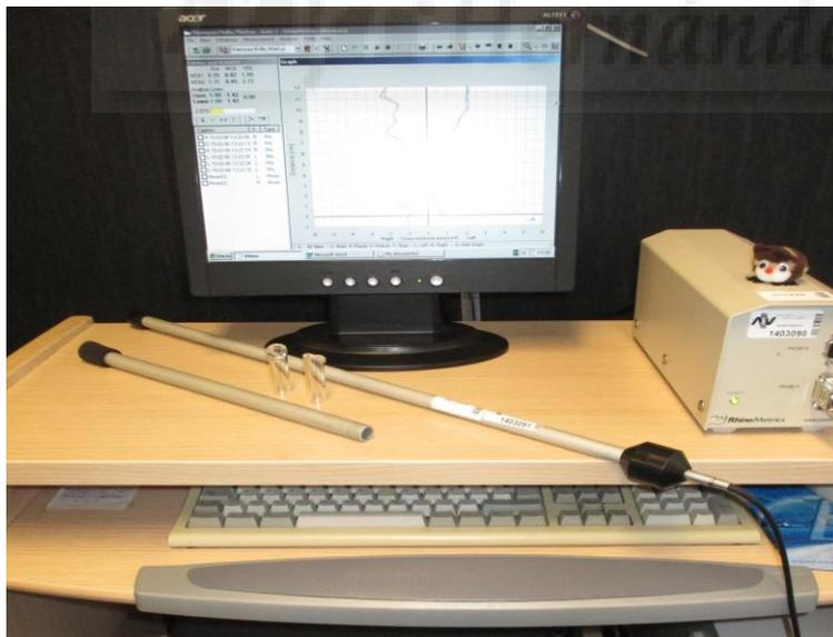
**Figura 1. Rinómetro *RhinoScan* de *Rhinometrics***
