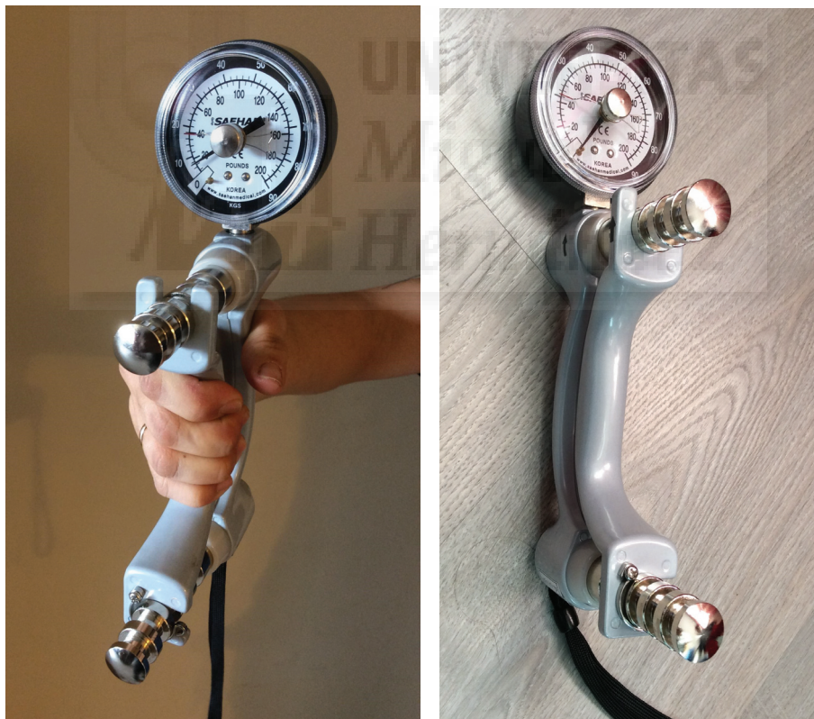
Figura 6. Dinamómetro hidráulico manual Saehan SH 5001 (nº serie 002025)
