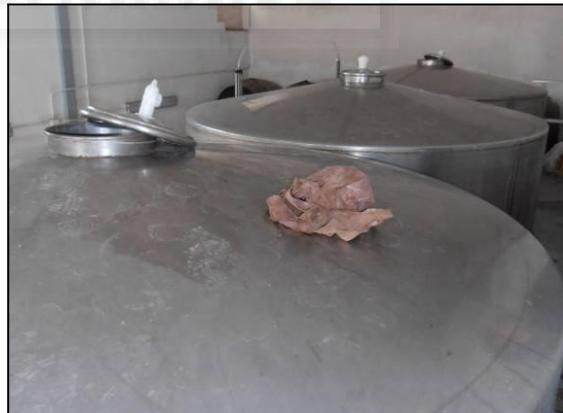
**Figuras 1.10 y 1.11. Parte superior de los depósitos protegida mediante barandillas de protección (izquierda) frente a desprotegida (derecha)**
