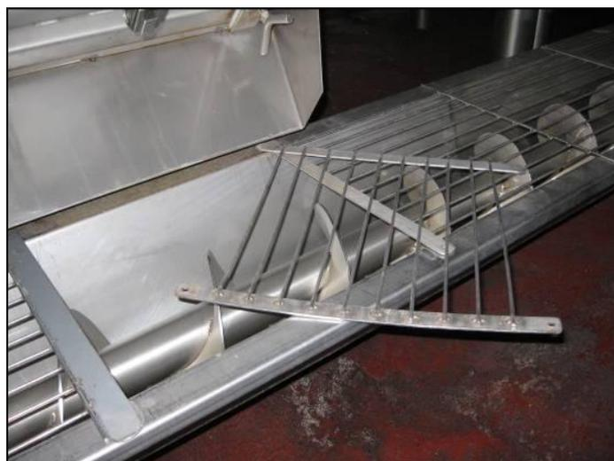
Figura 1.14. Tornillos sinfín para el trasiego de hollejos a la prensa (elementos móviles accesibles)
