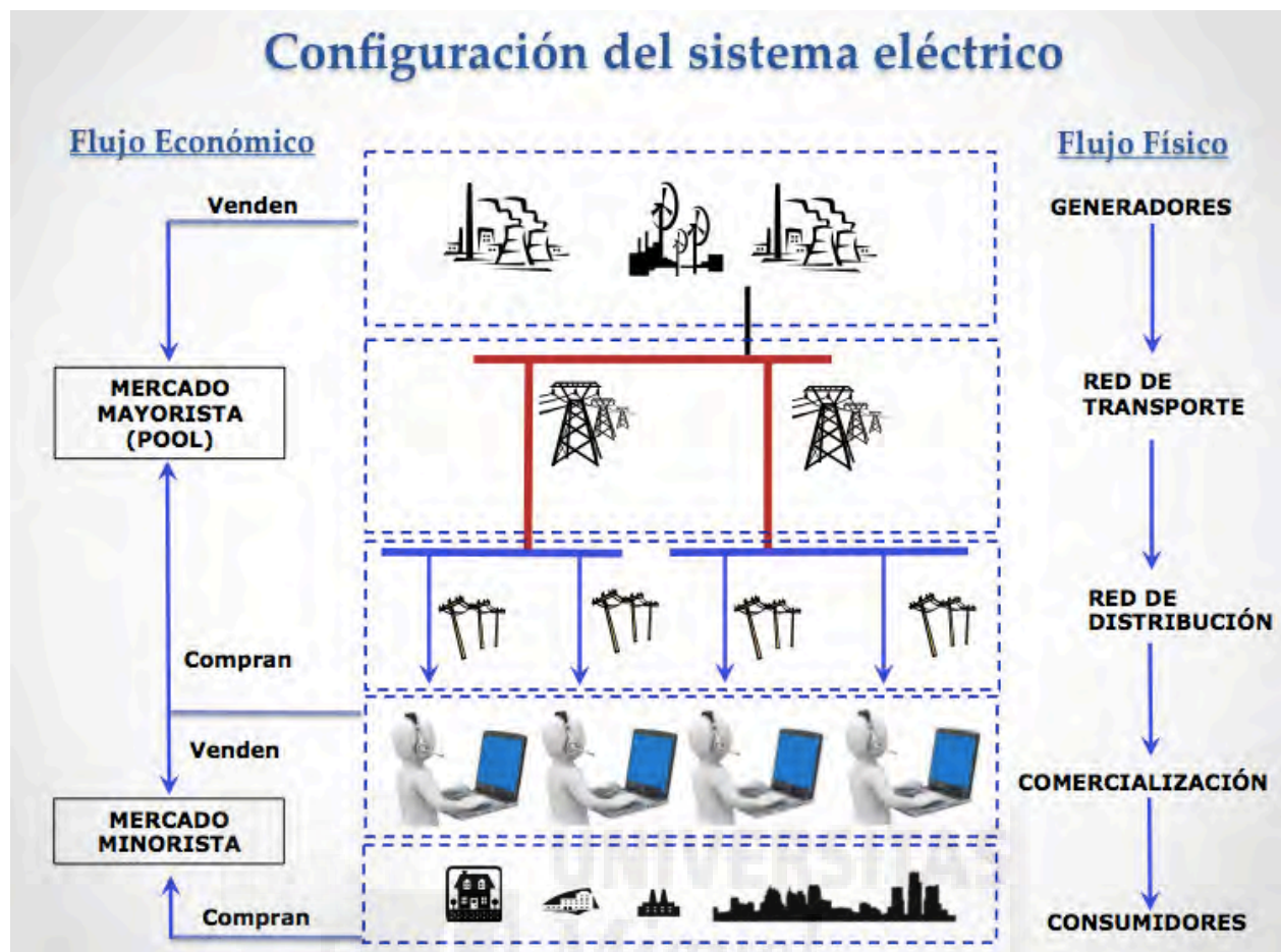
Figura 84. Configuración del sistema eléctrico. Flujos físico y económico. Fuente: elaboración propia
