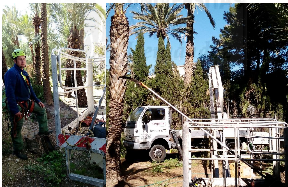
Figura nº 24. Grúa para realizar los trabajos en altura en las palmeras. Fuente propia.
