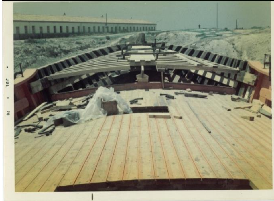
Imatge nº 85.- Coberta i escotilles. Font: Arxiu Drassana Zaragoza.
