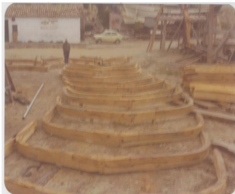
Imatge nº 69.- Les quadernes a la Drassana Zaragoza. Font: Arxiu Zaragoza.
