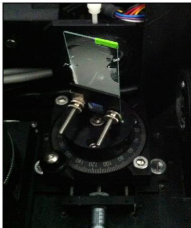
Figura 12: Soporte para muestras en estado sólido (peana giratoria).
