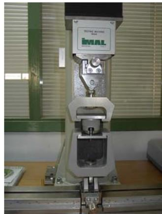
Figura 3.19. Tornillo insertado en la probeta y el ensayo.
