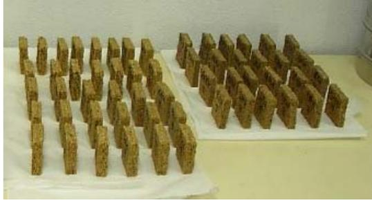
Figura 3.16. Algunas probetas después de inmersión en agua.
