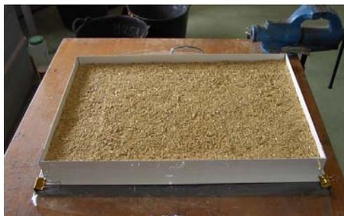
Figura. 3.6. Molde para formar la manta del tablero.
