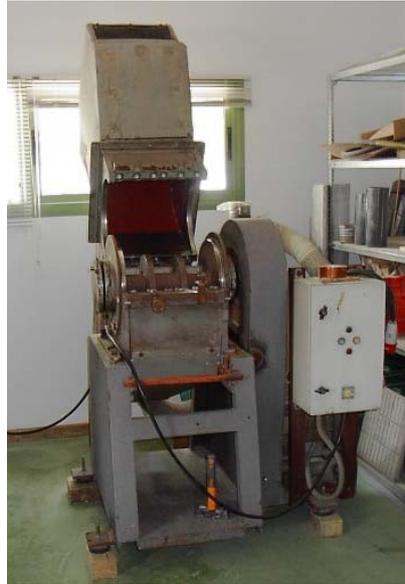
Figura. 3.4. Desfibradora de cuchillas.
