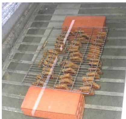
Figura 3.15. Algunas probetas en inmersión en agua.
