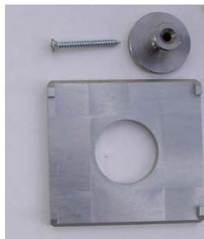
Figura 3.17. Dispositivos mecánicos para arranque de tornillo en la cara.
