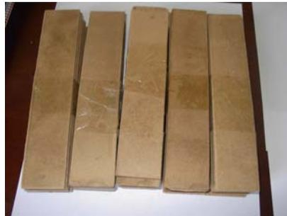
*Figura 4.18. Ejemplo de probetas para ensayos a flexión.*
