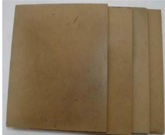
Figura 4.1. Diferentes tableros de caña- cemento.
