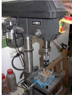
Figura 3.18. Taladro de las probetas para el ensayo de arranque de tornillo en la cara.
