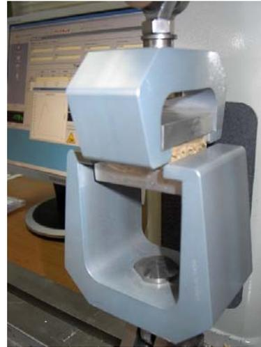
Figura 3.13. Tacos de agarre de probetas.
