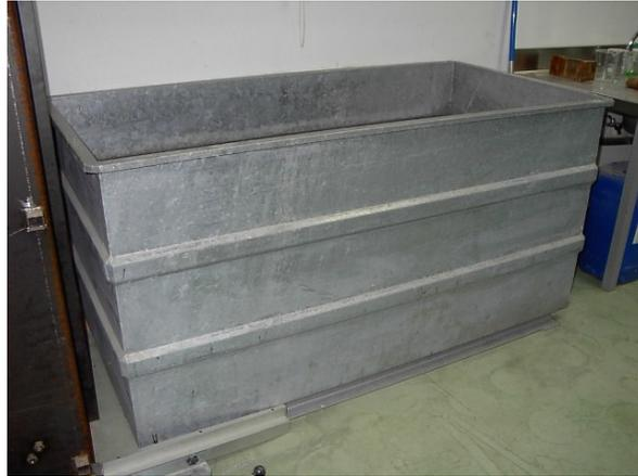
Figura 3.14. Cubeta para baño de agua con termostato.
