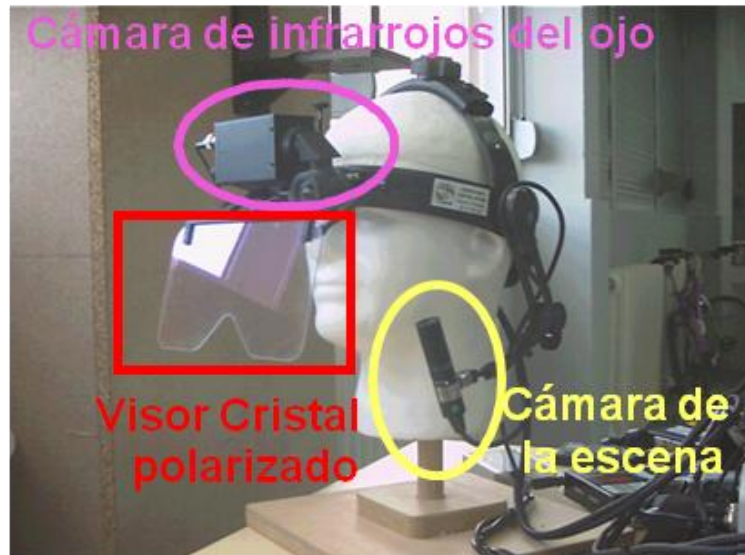
Figura 2.1. Sistema de Seguimiento de la Mirada y componentes, que se coloca en la cabeza del árbitro.
