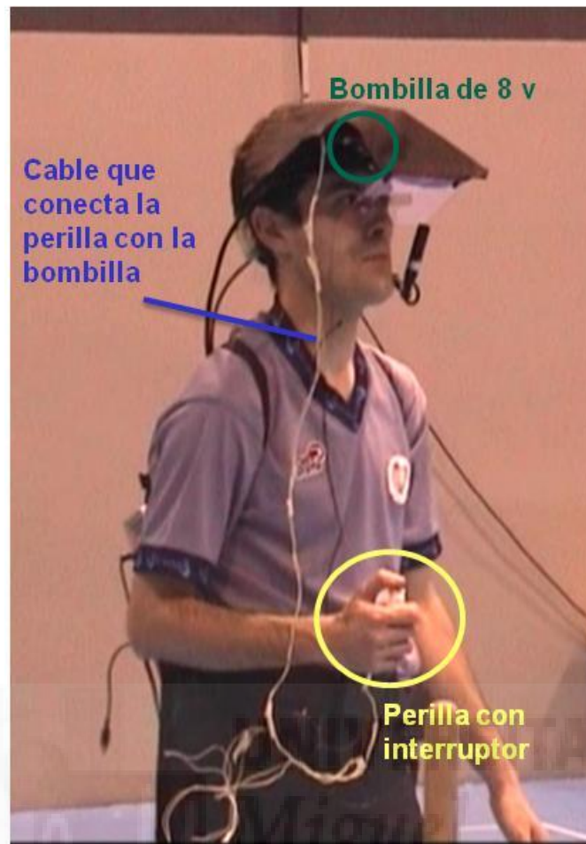
Figura 2.5. Sistema para registrar el momento en que el árbitro señalizaba una infracción en el juego.
