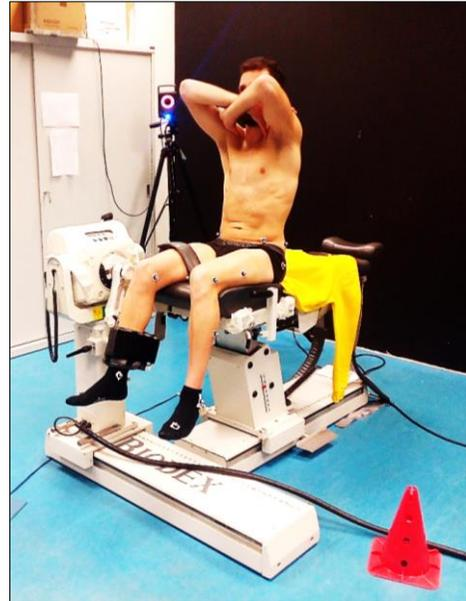
El ángulo de la rodilla fue registrado tanto con el Sistema Vicon®MX T-10, como con el sistema Biodex System 4, con la intención de comparar ambas mediciones durante todo el recorrido de extensión de rodilla.
