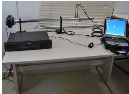
Figura 1. Montaje de tubo de impedancia para la determinación del coeficiente de absorción
