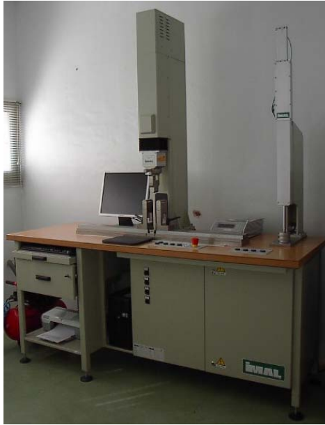
Fig. 4. Máquina de ensayos universal para madera.
