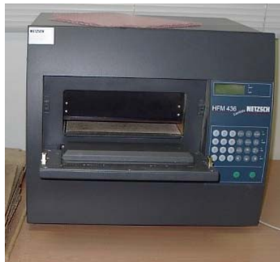
Fig. 5. Equipo de conductividad térmica por medio del flujo de aire.
