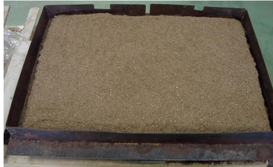
Fig. 2. Molde para formar la manta.
