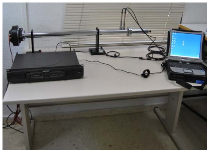
Fig. 8. Montaje del tubo de impedancia.
