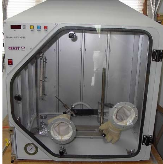
Fig. 7. Equipo de inflamabilidad mediante aplicación directa de llama.
