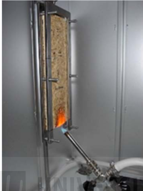
Fig. 6. Ensayo de inflamabilidad de una probeta.
