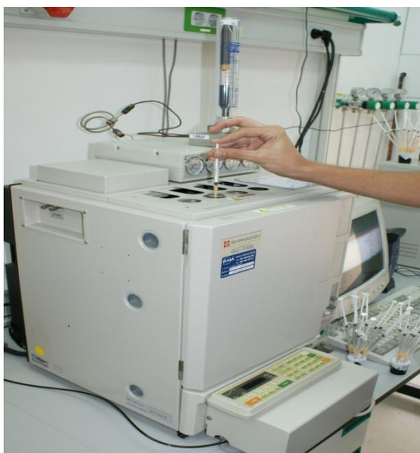
Figura 3.4 Cromatógrafo Shimadzu GC-14B Fuente: Foto del laboratorio.
