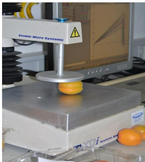
Figura 3.6 Texturómetro TA-XT2i. Fuente: Foto propia del laboratorio.
