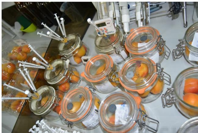
Figura 3.3 Extracción de gases de los frascos de vidrio. Fuente: Foto propia.
