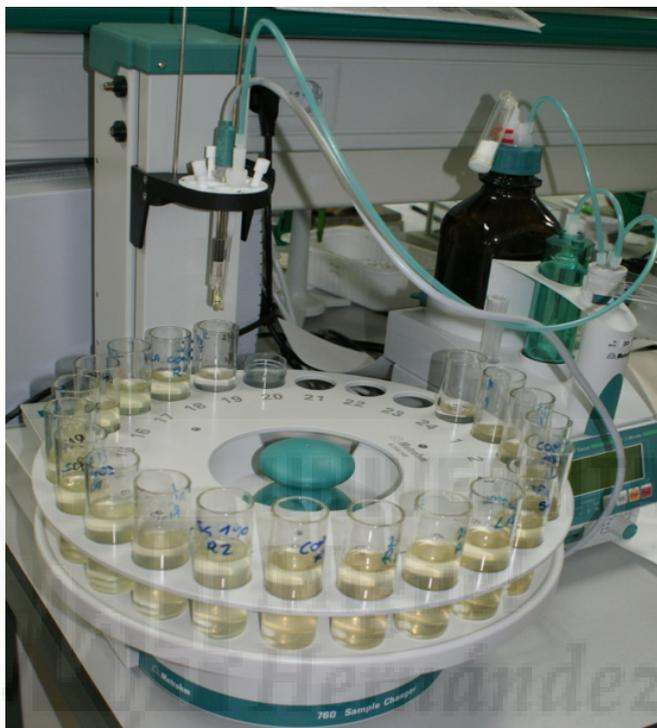
Figura 3.7 pH-metro Metrohm 760 Sample. Fuente: Foto del laboratorio.
