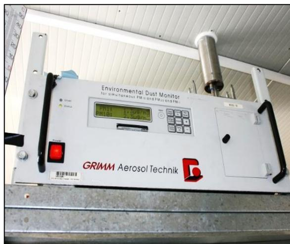
Figura 12. Contador óptico GRIMM modelo 190.
