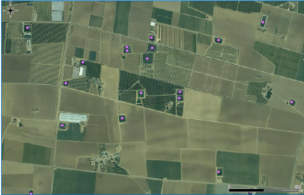
Figura 6: Representación del proceso de digitalización de los embalses de riego utilizando ortofotografías del PNOA máxima actualidad en QGIS.
