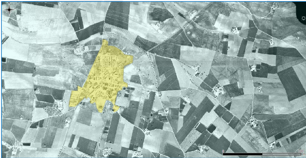
Figura 8: Representación del proceso de digitalización de áreas urbanas utilizando fotogramas del vuelo interministerial 1973-1986 en QGIS.
