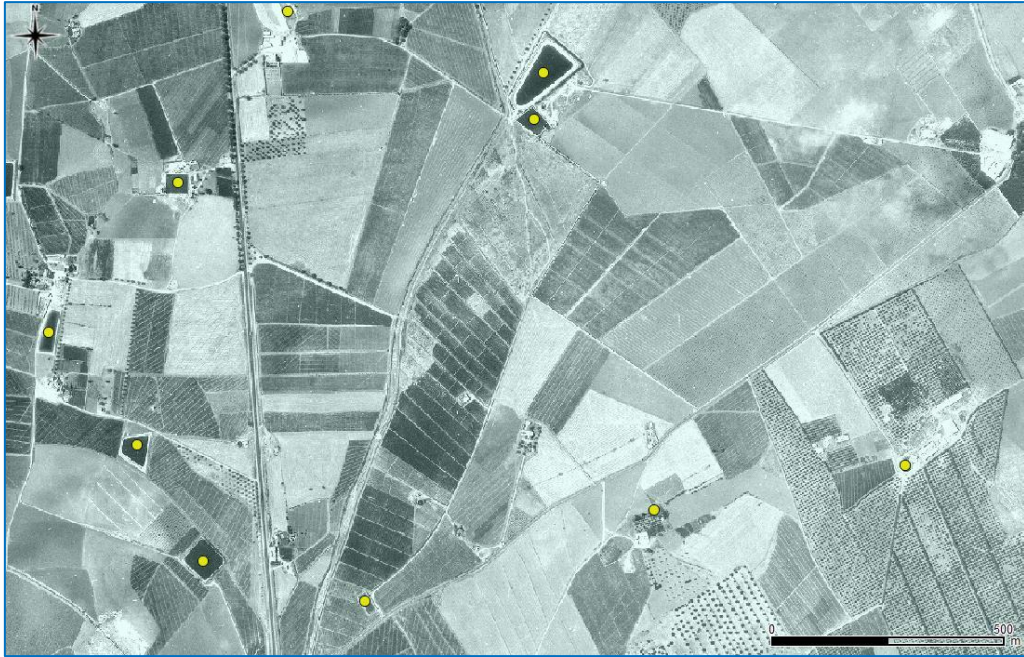
Figura 9: Representación del proceso de digitalización de embalses de regadío utilizando fotogramas del vuelo interministerial 1973-1986 en QGIS.
