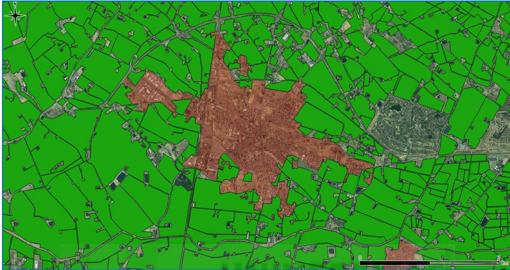
Figura 5: Representación del proceso de digitalización de las principales áreas urbanas utilizando ortofotografías del PNOA máxima actualidad en QGIS.
