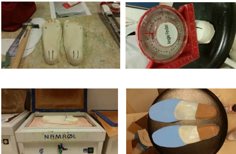
Figura 2: Proceso de confección de la ortesis.
