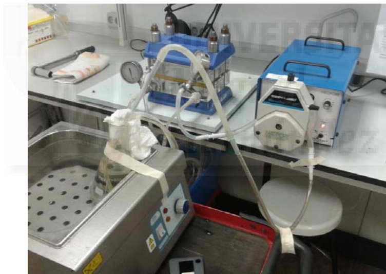
Figura 8: Ultrafiltrador tangencial ( Pellicon ) con su montaje, utilizado en los experimentos de filtración de grandes volúmenes de cultivo.
