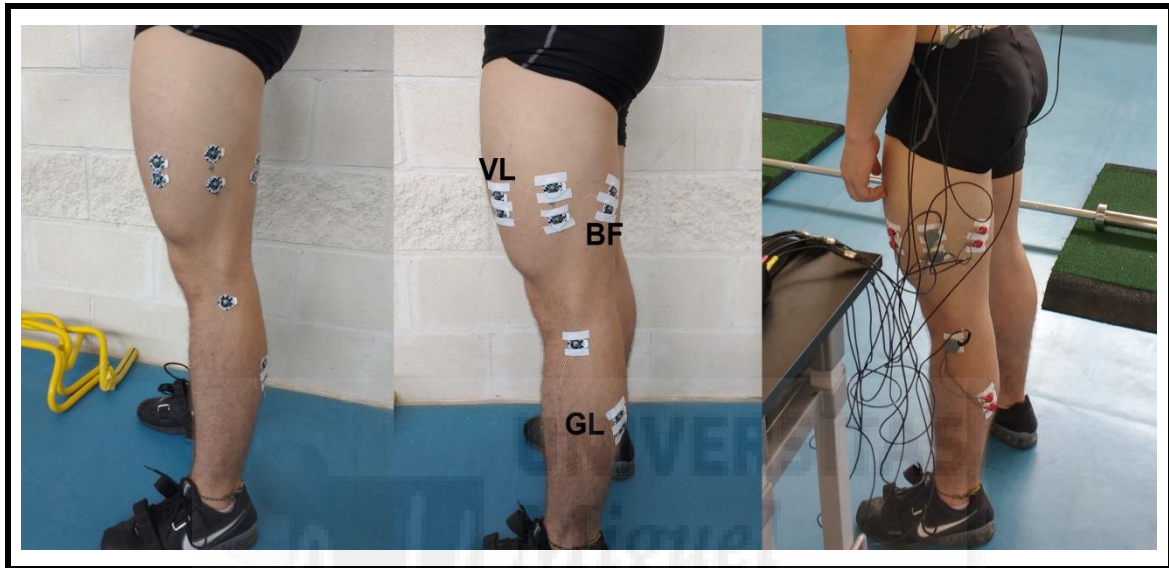
Figura 2. Localización de los electrodos sobre los músculos del muslo y la pierna del lado izquierdo: GL, gastrocnemius lateralis ; BF, biceps femoris ; VL, quadriceps vastus lateralis . El resto de electrodos son electrodos de referencia.
