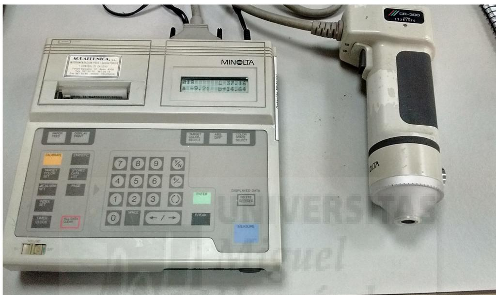
Figura 14: Colorímetro Minolta CR-300
