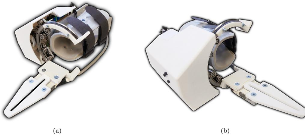
FIGURA 3.14: Prototipo final del exoesqueleto de pronosupinación con carcasa
