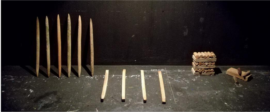
Fig. 6. Simulación. 10 birlos y restos de birlos rotos con ladrillo, todos originales del alfar de los Górriz .
