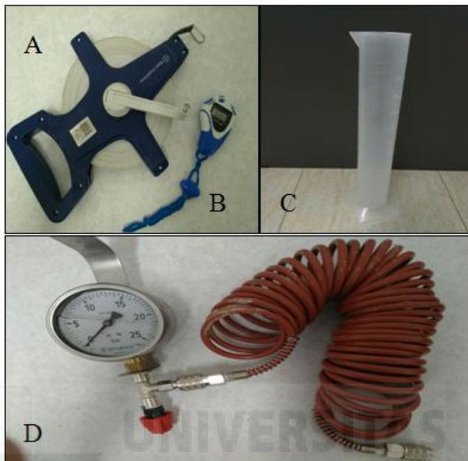
**Figura 20. Material necesario para la calibración de equipos. A,** cinta métrica (50 m). **B,** cronómetro. **C,** probeta graduada. **D,** manómetro y manguera de enganche al atomizador.
