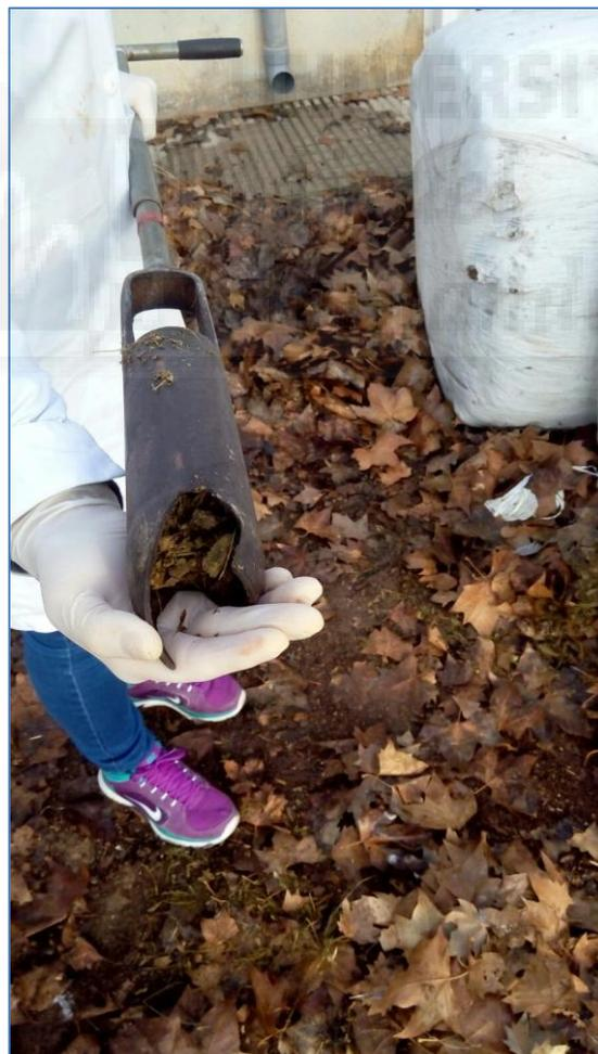
Figura 10. Utensilio toma-muestra del silo.
