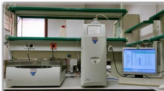
**Figura 4.** Cromatógrafo Dionex ICS-1100 utilizado para el análisis de cationes.
