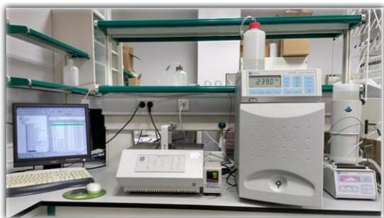
**Figura 3.** Cromatógrafo Dionex DX-120 utilizado para el análisis de aniones.
