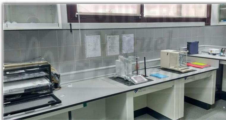
**Figura 6.** Sala para el acondicionamiento de los filtros previo al análisis gravimétrico.
