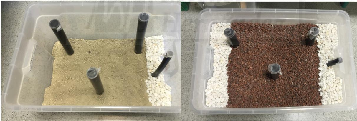
Figura 1. Fases iniciales de construcción del humedal de flujo superficial (izquierda) y del humedal de flujo subsuperficial horizontal (derecha).
