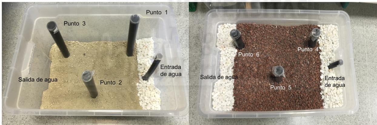
**Figura 4. Disposición de los puntos de muestreo en el humedal superficial (izquierda) y en el humedal subsuperficial (derecha).**
