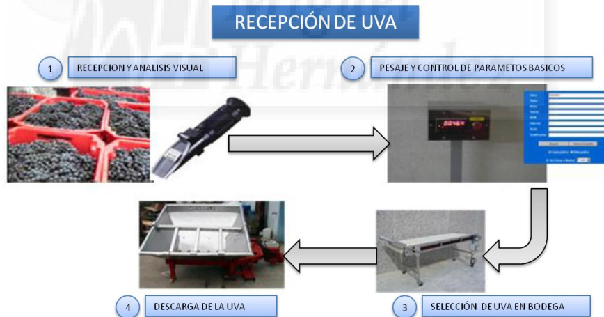
Figura 7-1. Esquema de actividades en la operación de recepción de uva (Pre-vinificación).
