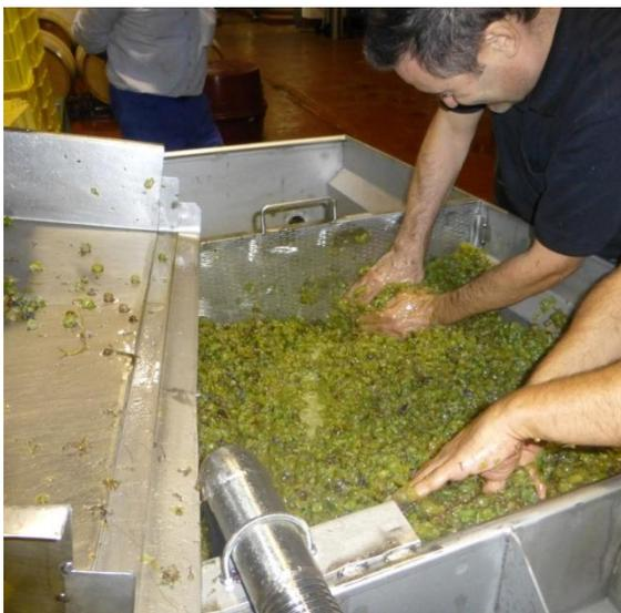
Imagen 68. Prensado manual tras despalillado y estrujado
