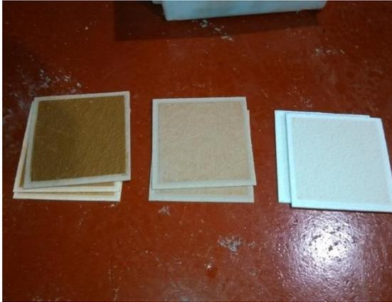
Imagen 82. Estado de los tres tipos de placas tras filtrado
