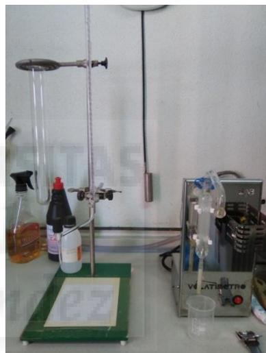
Imagen 85. Equipo medición acidez volátil
