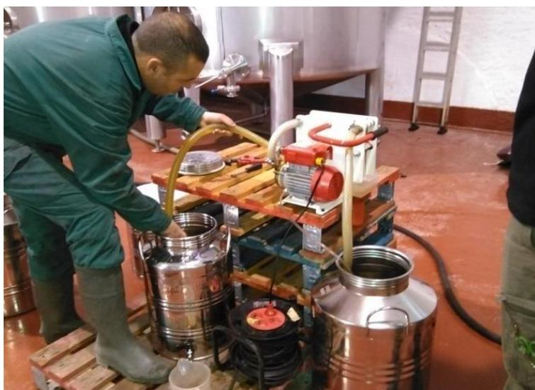
Imagen 81. Filtrado de los vinos mediante filtro de placas
