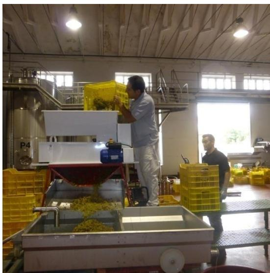
Imagen 67. Descarga de la uva en la despalilladora-estrujadora
