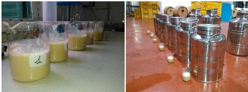
Imágenes 74 y 75. Preparación pie de cuba en laboratorio y posterior adición a los depósitos
