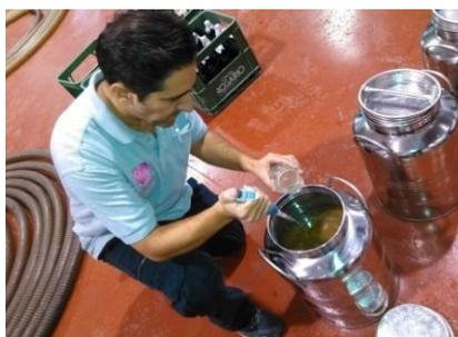
Imagen 80. Corrección de SO<sub>2</sub> en depósitos
