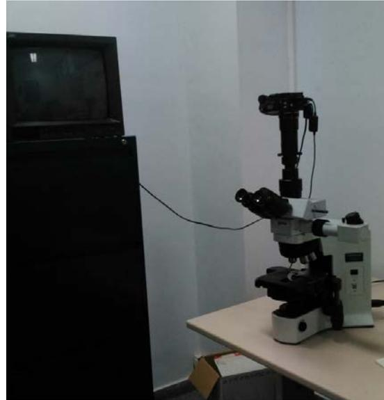
**Figura 9.-** Microscopio óptico acoplado a una cámara digital y una televisión.
