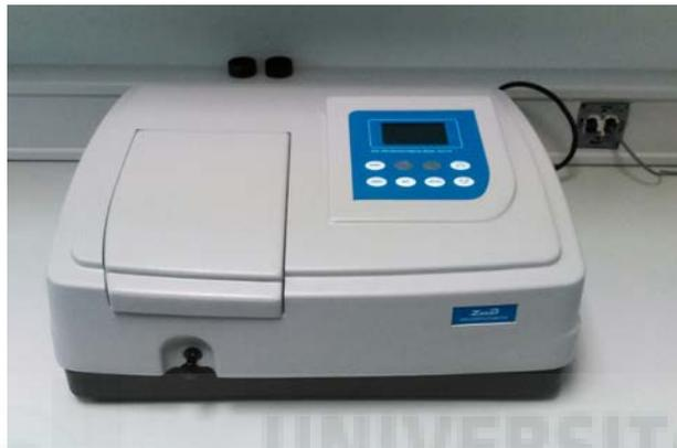
**Figura 16.-** Espectrofotómetro.
