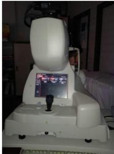
**Figura 3.2.1-2** Cuerpo OCT, cámara digital acoplada y pantalla táctil.
