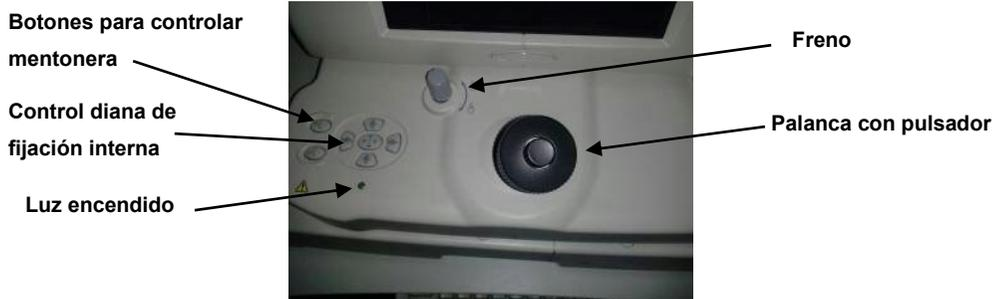
**Figura 3.2.1-3** Detalle de los mandos en la base de la OCT.
